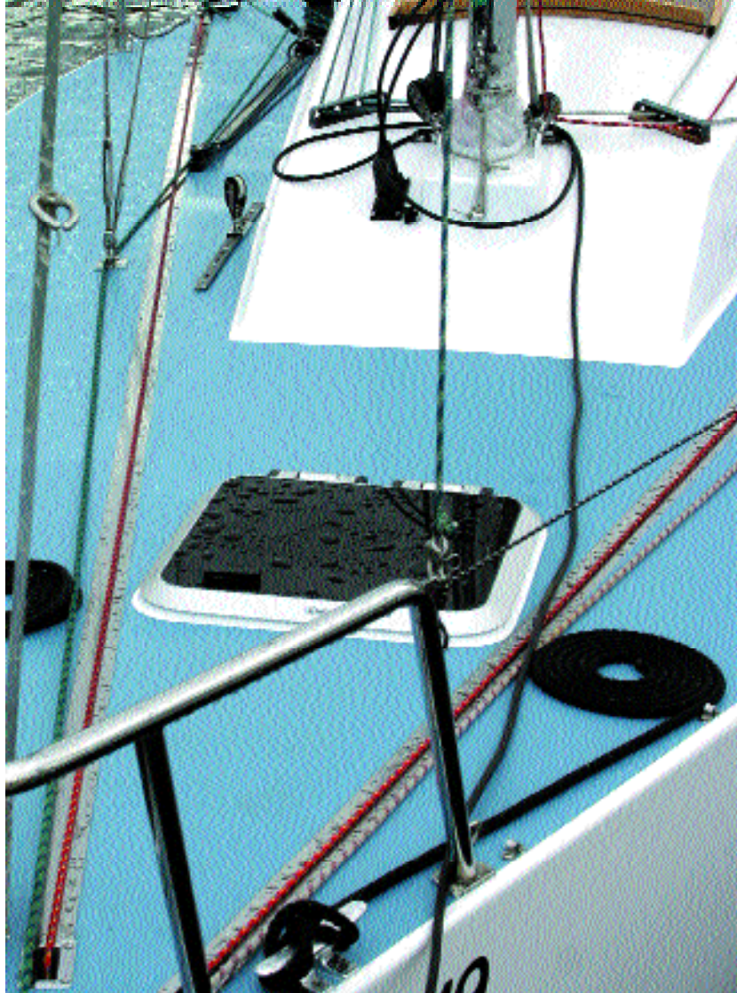
Die Winde im Vorschiff zieht die rote „Zugleine“ nach vorn. Deren anderes Ende wird auf einer federbelasteten Spule nach dem Prinzip des Rolladengurtes ebenfalls unter Deck aufgewickelt. An der Leine hängt ein Kunststoffschlitten mit einem Karabiner, in den die grüne Genuaschot eingehängt wird. Das Edelstahlband dient als Scheuerschutz zwischen Schlitten und Decksbelag.
